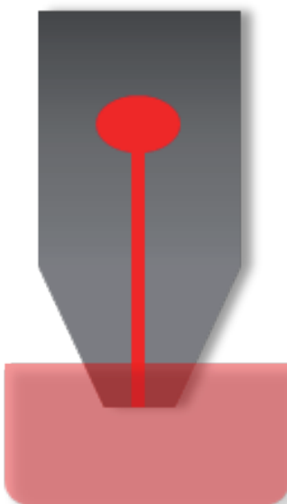
Düsenmundstück mit Jowat® Spülmittel vor Reaktion mit Feuchtigkeit schützen
