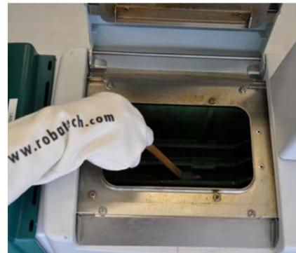
Anschließend etwas Jowat-Toptherm® aufschmelzen und den Tank erneut über das Ablassventil entleeren.
