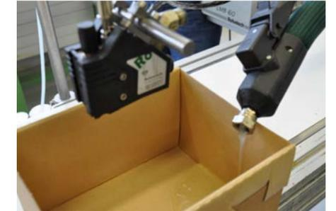
Als nächstes die Düsen spitzen der Auftragsköpfe demonstrieren, die Heizschläuche montieren und ebenso einzeln mit Klebstoff spülen.
