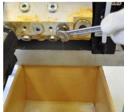
Die Filterpatrone demontieren, prüfen, reinigen und ggf. ersetzen. Anschließend wieder montieren und den Tank erneut mit Jowat-Toptherm® befüllen und aufschmelzen. Folgend etwas Klebstoff über das Ablassventil entnehmen, bis die Luft aus dem System entwichen ist. Danach die Temperaturen um ca. 30 - 40°C absenken (bis knapp oberhalb des im Technischen Datenblatt angegebenen Erweichungsbereiches).
