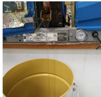
Die Filterpatrone demontieren, prüfen, reinigen und ggf. ersetzen. Anschließend wieder montieren und den Tank erneut mit Jowat-Toptherm® befüllen und aufschmelzen. Folgend etwas Klebstoff über das Ablassventil entnehmen, bis die Luft aus dem System entwichen ist. Danach die Temperaturen um ca. 30 - 40°C absenken (bis knapp oberhalb des im Technischen Datenblatt angegebenen Erweichungsbereiches).
