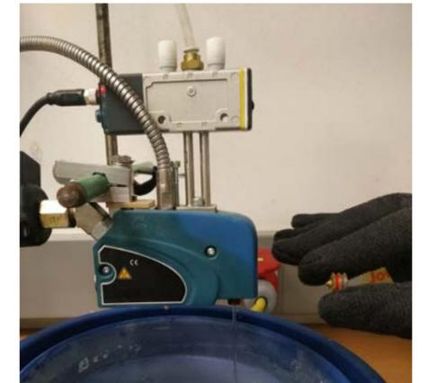
Zum Schluss den Inlinefilter demontieren, prüfen, reinigen und ggf. die Filterpatrone ersetzen. Darauf folgend Inlinefilter und Düsen spitzen wieder montieren und etwas Klebstoff über die Düsen spitze entnehmen, bis die Luft aus dem System entwichen ist. Schließlich Druck und Temperatur auf Verarbeitungsbedingungen einstellen.
