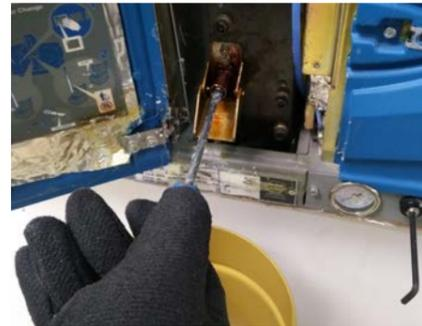
Anhaftende Rückstände mit einem geeigneten Werkzeug aus dem Tank entfernen (dabei darauf achten, keine metallischen Werkzeuge einsetzen, um die Antihftbeschichtung der Oberfläche nicht zu beschädigen).
